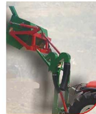
Limpiador acoplado sobre contenedor de los frutos del suelo, con bastidor hidráulico.
