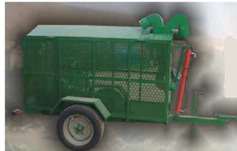
Limpiador acoplado sobre remolque arrastrado o suspendido
