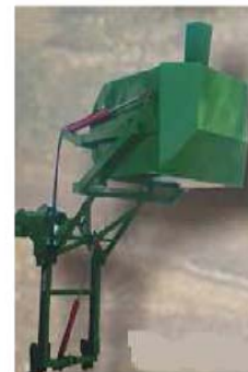
Limpiador acoplado sobre contenedor de los frutos del suelo, con bastidor hidráulico.
